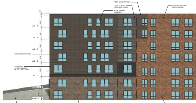
3 - LOWER - SW ELEVATION SCALE: 1/8" = 1'-0"
