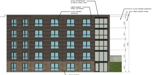
5 - UPPER - WEST ELEVATION SCALE: 1/8" = 1'-0"
