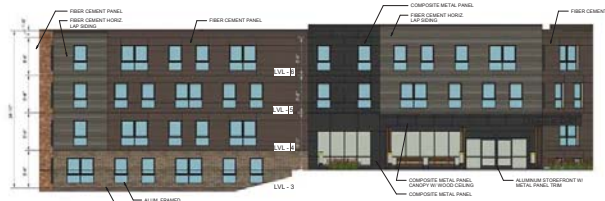
3 - UPPER - EAST ELEVATION SCALE: 1/8" = 1'-0"
