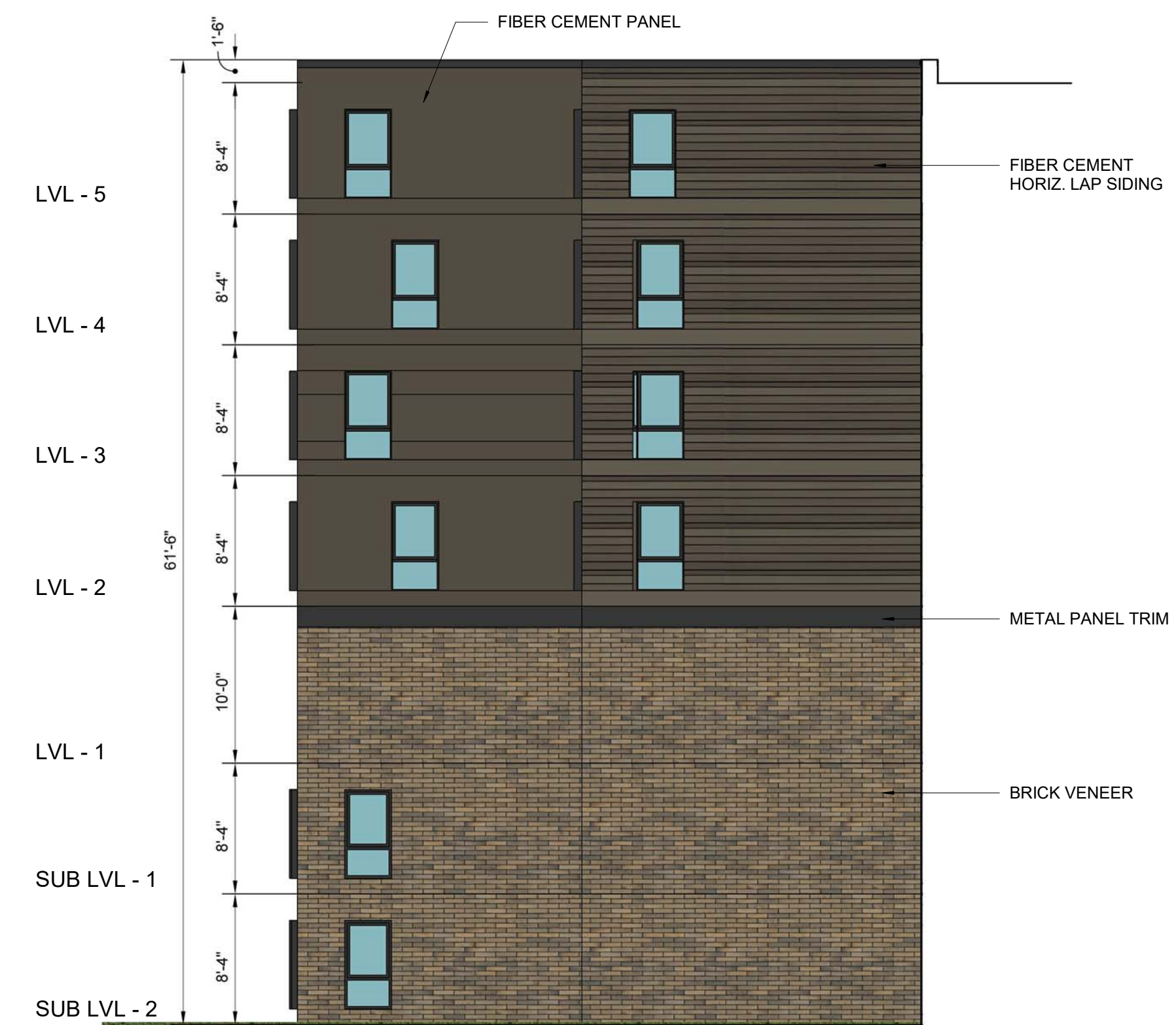
4 - LOWER - SE ELEVATION SCALE: 1/8" = 1'-0"
