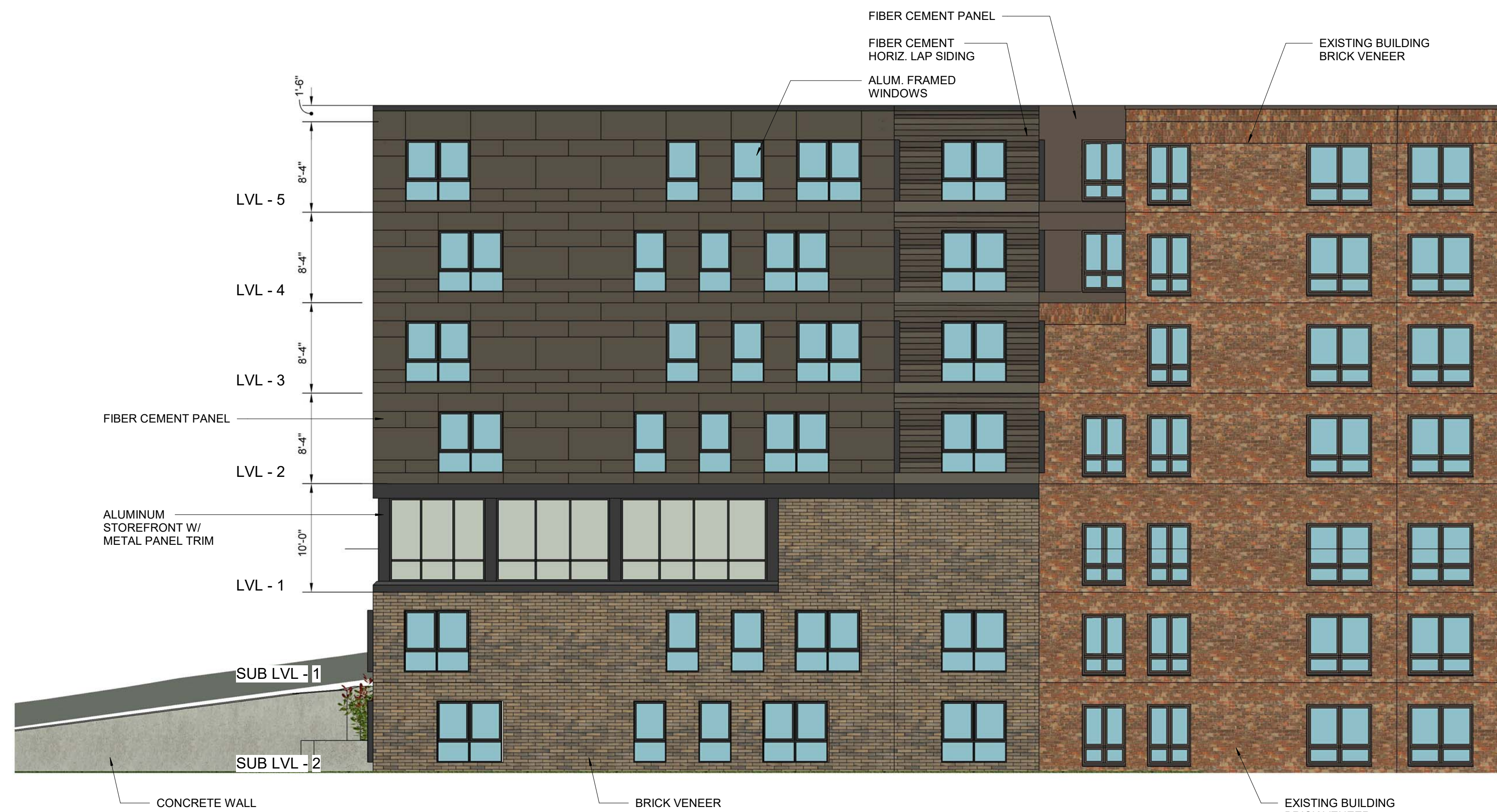
3 - LOWER - SW ELEVATION SCALE: 1/8" = 1'-0"
